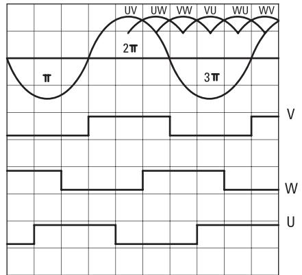
换向通道V的上升沿与反电动势UV之间的对准误差<=5电气角度。
